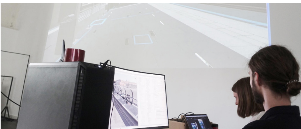
Abbildung 3: Prozessbild im VR-Lab: Stationsbegehungen und die Interaktionsprozesse der Probandinnen und Probanden können mittels Positions-, Kopfbewegungs- und Augenbewegungsdaten exakt getrackt werden.
